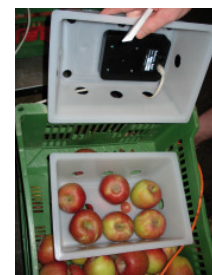
Mit Fluoreszenz-Sensoren wird der physiologische Zustand der Früchte im Lager gemessen.
