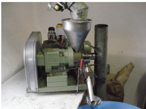
Mittels einer Schneckenpresse wurden die „Kerne“ gepresst.
