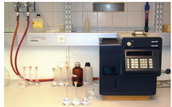
Mit Hilfe des Flammenphotometers wird der Gehalt an ausgetauschten Kationen (Calcium, Magnesium, Kalium und Natrium) bestimmt.
