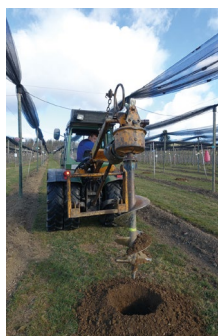
Mit einem Erdbohrgerät wurden die Löcher gebohrt, in denen die Frostkerzen zur Beurteilung des Strahlungswärmeanteils versenkt wurden.
