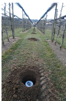
Mit einem Erdbohrgerät wurden die Löcher gebohrt, in denen die Frostkerzen zur Beurteilung des Strahlungswärmeanteils versenkt wurden.
