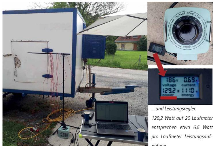
Der Versuchsstand mit Kühlanhänger...
