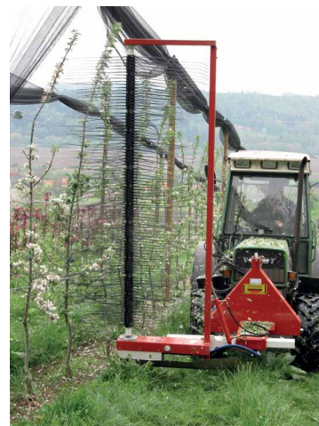
Maschinelle Ausdünnung mit Tree Darwin (6 km/h und 220 U/min) – Vollblüte
