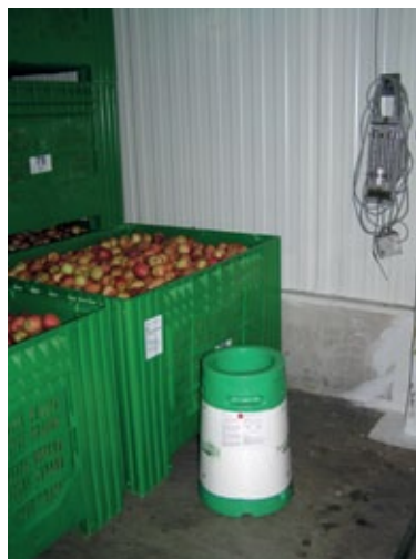
Abb. 3: Generator für die Applikation von SmartFresh im Obstlager
