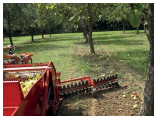
Bei richtiger Fahrgeschwindigkeit und Einstellung des Plantagenrotors nahm das Gerät alle Früchte auf
