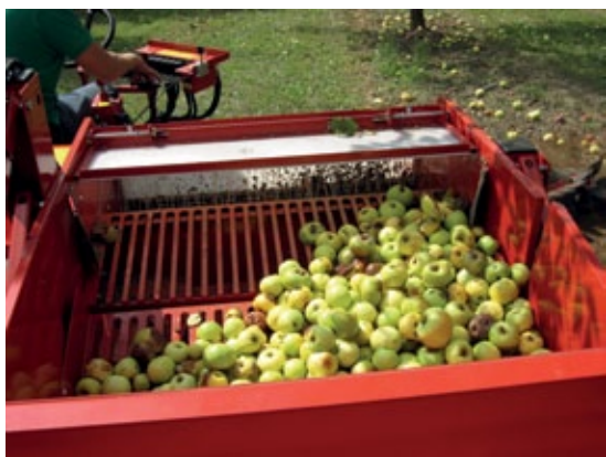
Die Äpfel gelangen unverletzt und fast ohne Verunreinigung in den Sammelbehälter
