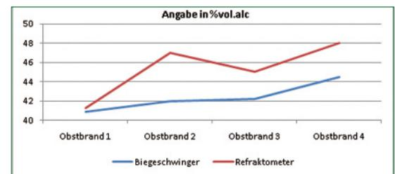
Auch nach Neujustierung auf 40 % vol lagen die Messwerte vom Refraktometer weit von denen des Biegeschwingers entfernt.
