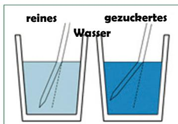
Wenn ein Strohhalm in ein Glas Wasser gestellt wird, erscheint er durch die Lichtbrechung gekrümmt. Stellt man ihn in ein Glas Wasser mit gelöstem Zucker, erscheint die Krümmung noch stärker. Das Ausmaß der Lichtbrechung (wie stark gekrümmt der Strohhalm erscheint) steigt proportional zur Dichte einer Substanz (wie viel Zucker im Saft gelöst ist).
