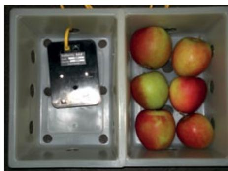
Abb. 1: DCA<sup>CF</sup> Lagertechnik mit Messboxen (Harvest-Watch System)
