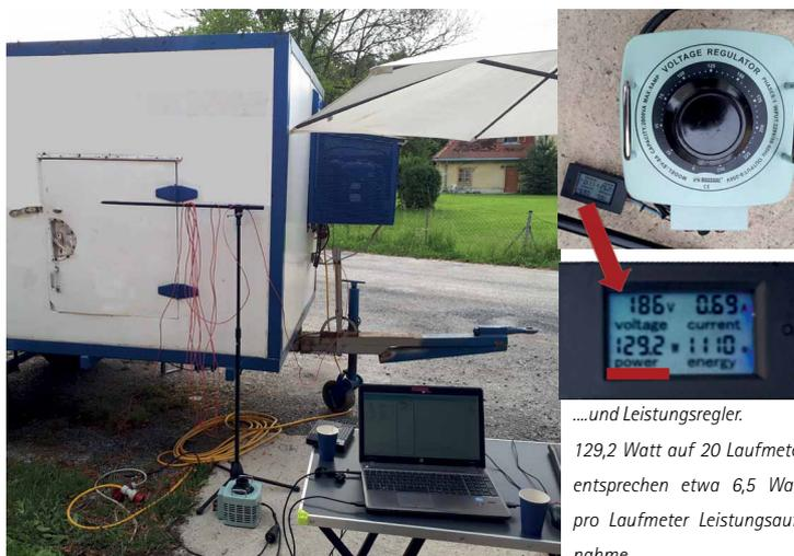
Der Versuchsstand mit Kühlanhänger...
