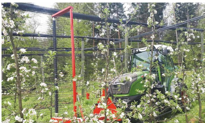
Ausdünnmaschine Tree Darwin wird vor allem bei den Bioausdünnversuchen eingesetzt
