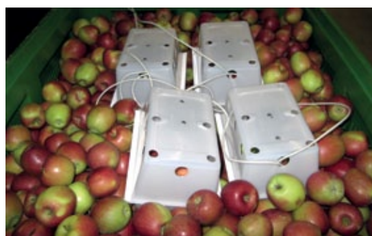
Abb. 1: Fluoreszenzsensoren im Obstlager
