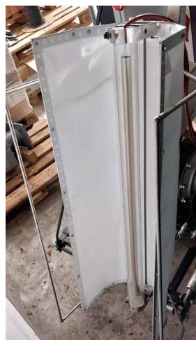
Das UV-Gerät wurde von der Schweizer Firma Aquanetto zur Anwendung im Feld entwickelt. Es arbeitet mit einer Wellenlänge von 222 nm und kann auch einfach auf eine Sortieranlage aufgebaut werden, um dort die Äpfel direkt beim Durchlaufen zu bestrahlen. Versuche dazu wurden gerade begonnen.
