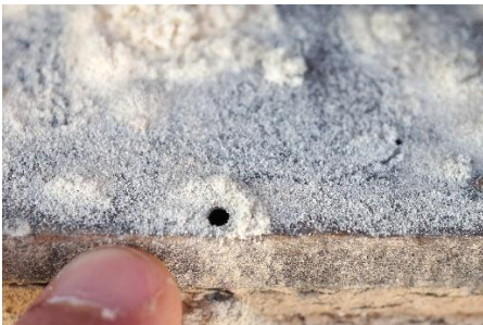
Bohrkäfer-Bohrmehl aus einer Palette (meist puderartig fein , Bild: A10)
