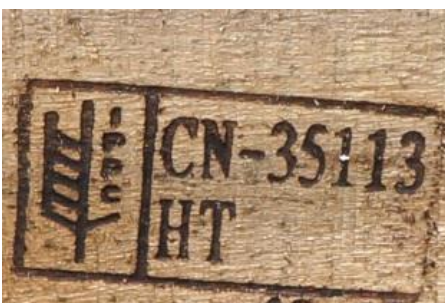
IPPC-Markierung einer schädlingsbekämpften Palette, die Buchstaben IPPC in der Getreideähre werden von allen Herstellern verwendet (Bild: A10)
