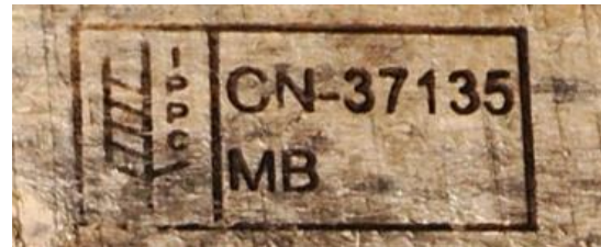
Markierung einer schädlingsbekämpften Palette: IPPC Symbol, Ländercode (CN=China), Betriebsnummer, (MB=chemische Behandlung; auch möglich: HT=Hitzebehandlung) (Bild: A10)
