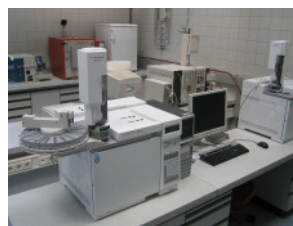
Mittels Gaschromatographie wird der Gehalt an Fuselölen, Ethanol sowie von flüchtigen Säuren und deren Estern bestimmt.
