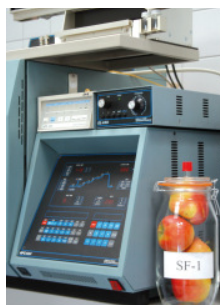
Mittels Gaschromatographen wird der Ethylengehalt im Glasgefäß gemessen.
