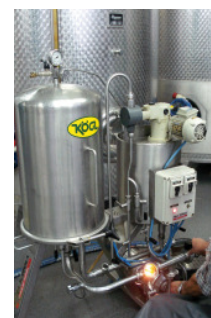
Der konventionelle Kieselgurfilter eignet sich ohne Adaptierungen zum Filtrieren mit Zellulose.
