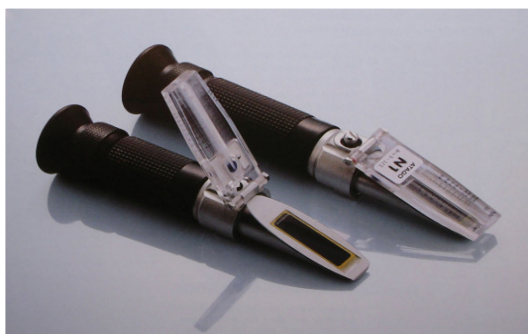
Einfaches Handrefraktometer zur Bestimmung des Trockensubstanzgehalts.
