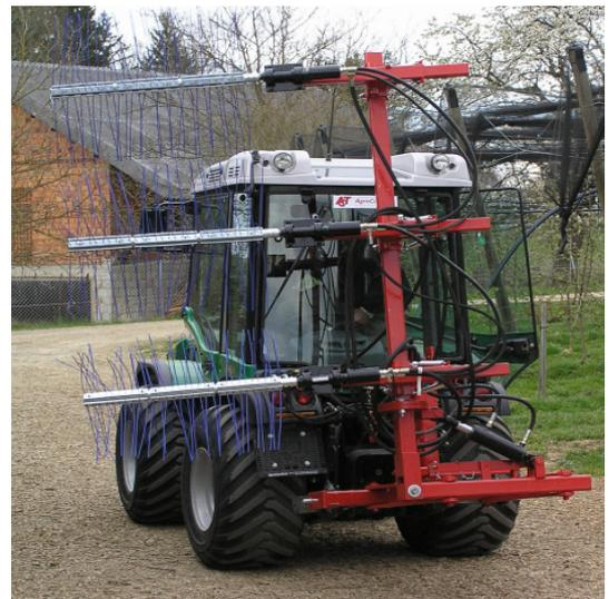
Abb. 3: Ausdünnmaschine entwickelt von der Universität Bonn.
