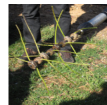
Electro'flor ist ein neues händisches Ausdünngerät, das mit Akkus betrieben wird.
