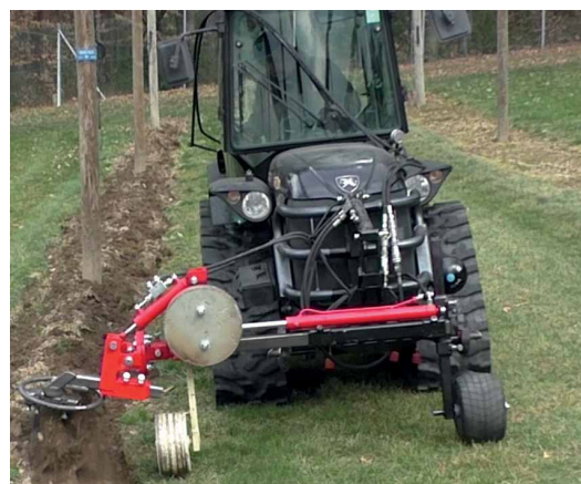
Traktor mit Rollhacke im Weinbau
