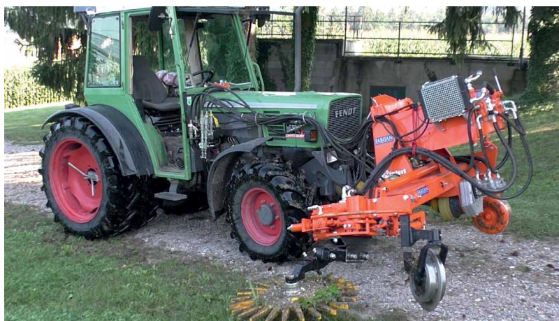
Traktor mit Fingerhacke im Obstbau
