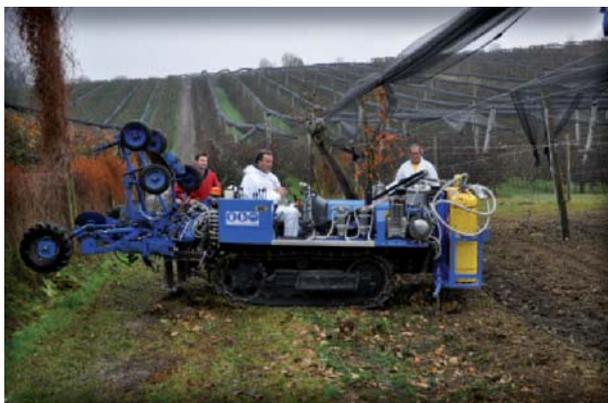
Mit solchen Geräten wird von der italienischen Fa. TRIS die Injektion direkt in den Boden durchgeführt. Eine weitere Möglichkeit ist die Ausbringung über Tröpfchenbewässerung.
