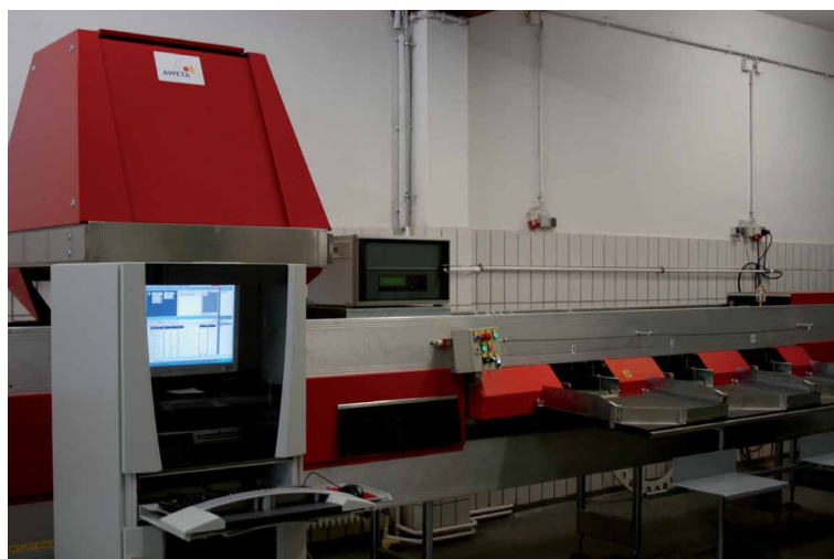
Bestimmung der Farbwerte mit der optischen Sortiereinheit der Aweta „HSG“ Sortiermaschine
