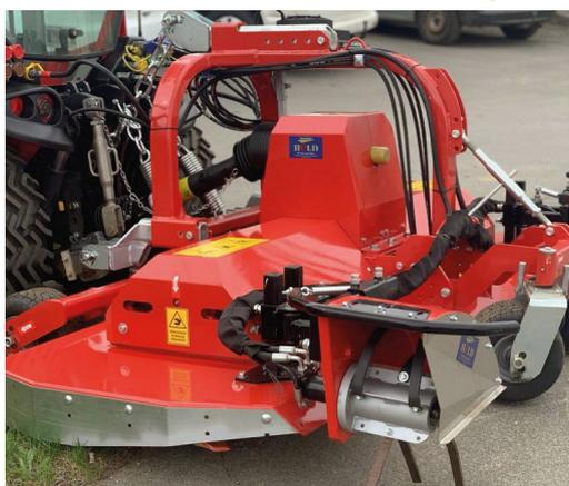
Die Bearbeitung findet hier beidseitig statt. Die Bürsten sind allerdings so konstruiert, dass sie bei jedem Mulcher nachgerüstet werden können. Der Mulcher wird an die Heckhydraulik angebaut. Durch die Wendesitzeinrichtung wird die Mulch-Bürst Kombination allerdings in Fahrtrichtung geschoben, was die Ge-
