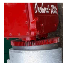
Der Contourhead ermöglicht einen variablen Hangaussgleich
