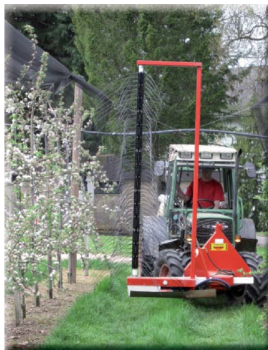
Abbildung 2: Die Ausdünnmaschine Tree – Darwin von H. Gessler, Bodensee
