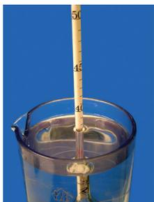
Senkwaagen (Alkoholometer) messen nur in einem kleinen Bereich exakt.
