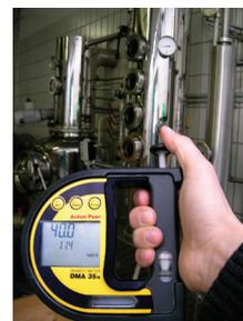
Die Alkoholmessung mittels Biegeschwinger ist auch im hochprozentigen Bereich exakt und erfolgt entweder in %vol oder %mas.
