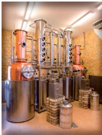
Selbst in modernen Brenn- anlagen lässt sich \text{SO}_2 beim Destillieren nicht abtrennen.
