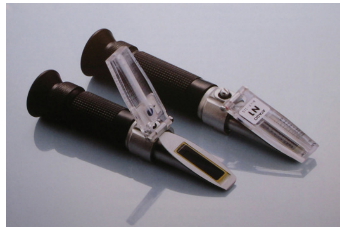
Refraktometer zur Messung des Zuckergehalts vor der Gärung.
