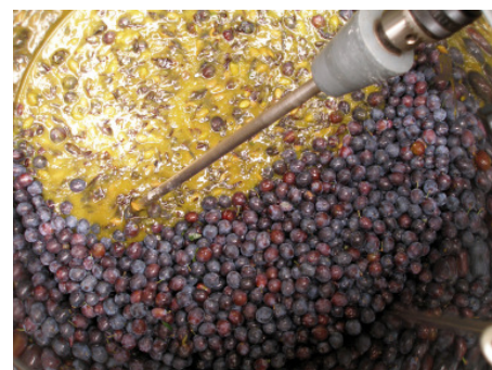
Beim Aufmischen der Früchte werden keine Steine zerstört.
