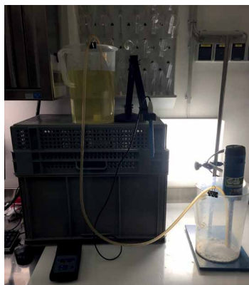
Abb. 5: Doppelsalzsäuerung mit pH-Wert Überwachung
