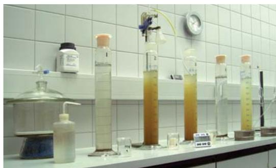
Bestimmung der Korngrößenverteilung einer Bodenprobe.
