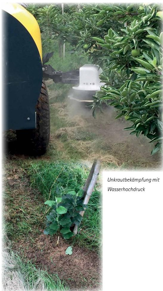
*Unkrautbekämpfung mit Wasserhochdruck*
