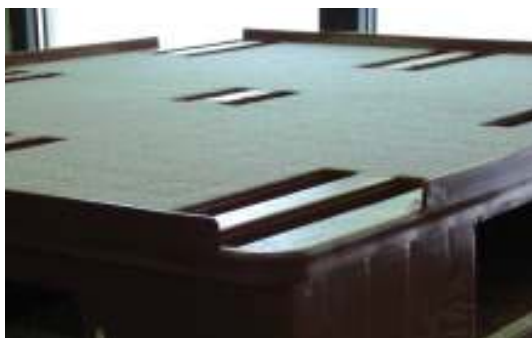
Sandbeschichtete Plastikpaletten gewährleisten den sicheren Transport.
