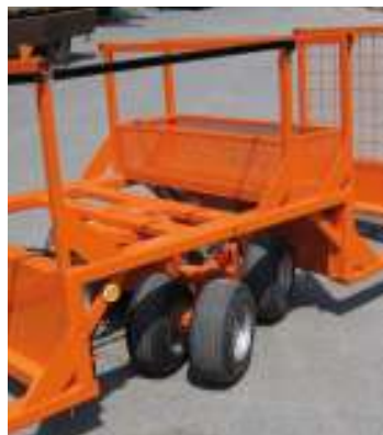
Engere Kurvenradien werden durch die lenkbare Tandemachse möglich.
