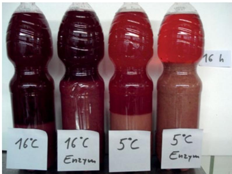
Abbildung 1: Die Varianten mit Enzymzusatz hatten mehr Absetztrüb.
