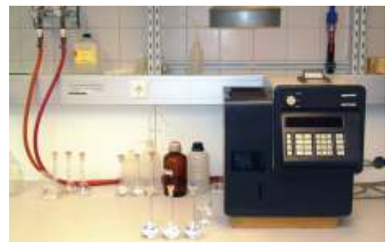
Mit Hilfe des Flammenphotometers wird der Gehalt an ausgetauschten Kationen (Calcium, Magnesium, Kalium und Natrium) bestimmt.
