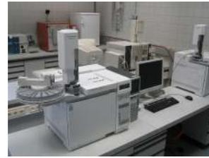
Mittels Gaschromatographie wird der Gehalt an Fuselölen, Ethanol sowie von flüchtigen Säuren und deren Estern bestimmt.
