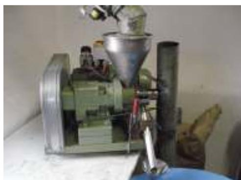
Mittels einer Schneckenpresse wurden die „Kerne“ gepresst.
