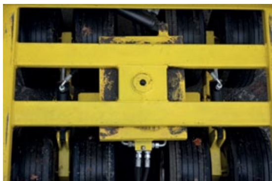
Die Last wird von 8 Rädern getragen
