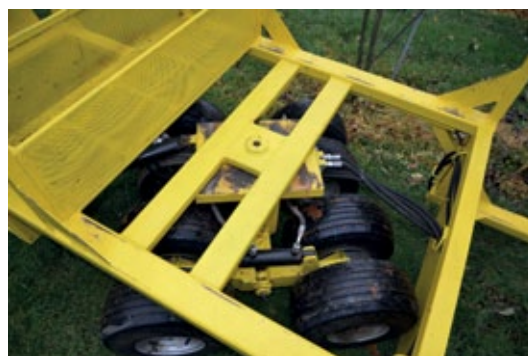
Der lenkbare Achsblock erleichtert das Einfahren in die Reihen.
