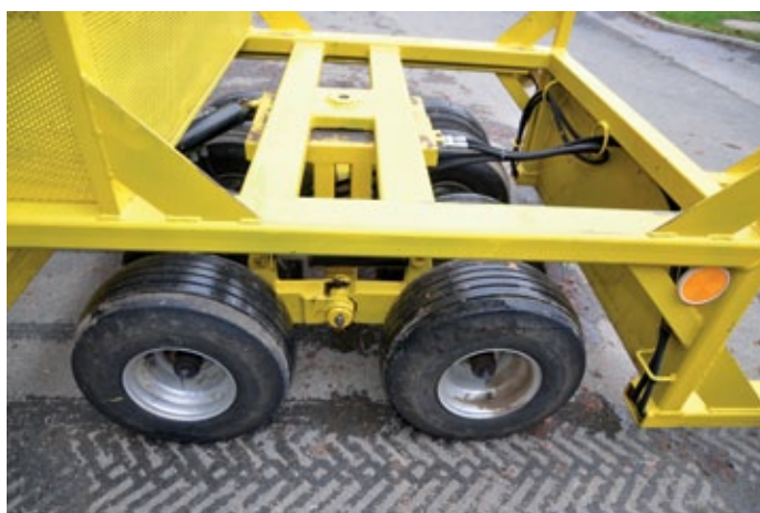
Die Räder laufen nicht in der Spur des Zugfahrzeuges.
