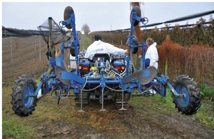
Das ist eines der Geräte die die italienischen Fa. TRIS für die Bodenentseuchung verwendet. Dabei wird die Injektion direkt in den Boden durchgeführt. Eine weitere Möglichkeit ist die Ausbringung über Tröpfchenbewässerung.
