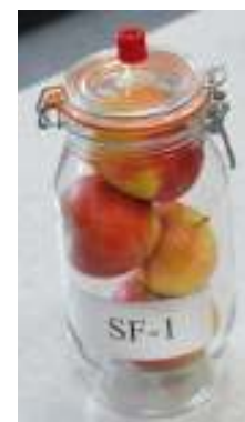
In speziellen Glasgefäßen wird die Menge an Ethylen, die von den Äpfeln abgegeben wird, gemessen.
