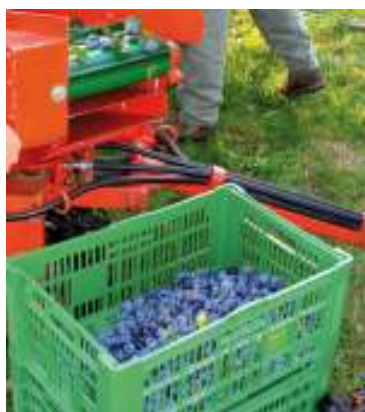
Mit einem Förderband gelangen die Früchte zur Kiste, dazwischen werden Blätter mit einem Gebläse ausgeblasen.
