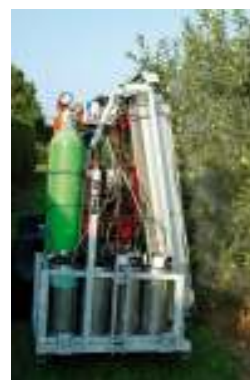
Durch den verstellbaren Luftdruck ist eine recht gute Anpassung an die Laubdichte möglich.
